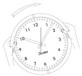
Als der Träger am Wand befestigt ist, drehen Sie eine viertel die Uhr im Uhrzeigersinn, um sie in ihrer richtigen Position zu hängen.
