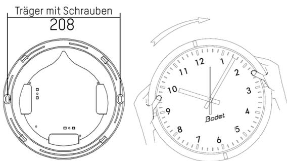
Als der Träger am Wand befestigt ist, drehen Sie eine viertel die Uhr im Uhrzeigersinn, um sie in ihrer richtigen Position zu hängen.
